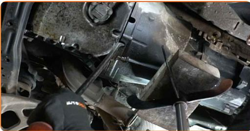
43 Išimkite pavarų dėžę. Naudokite hidraulinį pakelėją.
